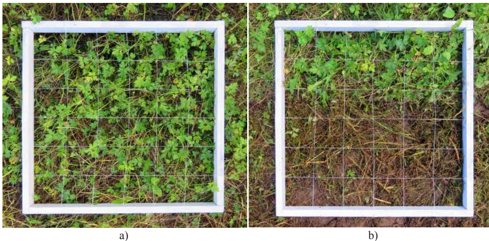
Р и с. 10. Внешний вид приствольных зон: а) до прохода агрегата; б) после однократного прохода агрегата
