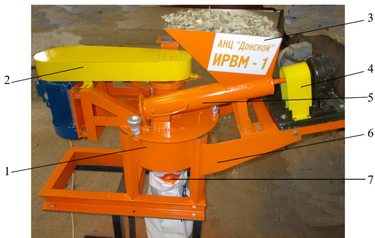
Р и с. 1. Экспериментальное устройство (общий вид): 1 – рабочая камера; 2 – привод ротора; 3 – загрузочный бункер; 4 – привод питающего шнекового транспортера; 5 – питающий шнековый транспортер; 6 – рама; 7 – выгрузная горловина
