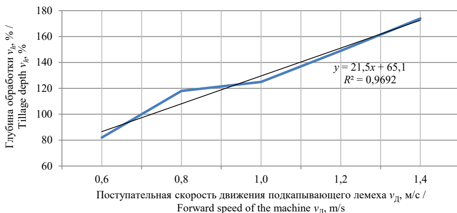
Р и с. 15. График зависимости коэффициента вариации глубины обработки ( v_h , %) от поступательной скорости движения машины ( v_d , м/с) при n_{до} = \text{const}
