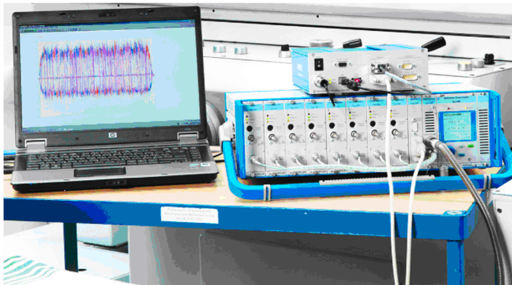
Р и с. 2. Фотография аппаратуры для усиления и оцифровки сигналов: ноутбук; усилитель сигналов
