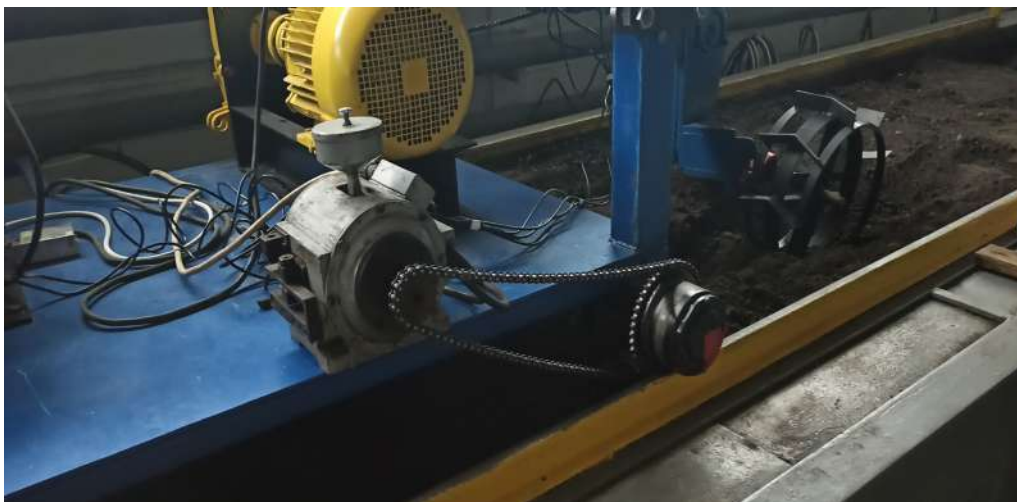
Р и с. 5. Динамический стабилизатор устойчивости движения подвижного модуля экспериментального стенда
