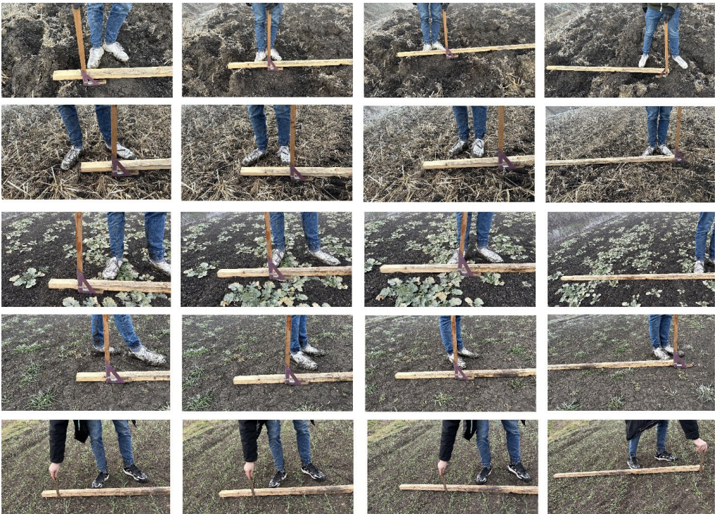
Р и с. 7. Измерение рельефа в точках последовательно справа налево: 0; 1,4; 1,6; 1,8 м по агрофону сверху вниз: вспашка; стерня риса; рапс; чистый пар; озимая пшеница F i g. 7. Terrain measurement at points successively from right to left: 0; 1.4; 1.6; 1.8 m by agrophonus from top to bottom: plowing; rice stubble; rape; clean fallow; winter wheat
