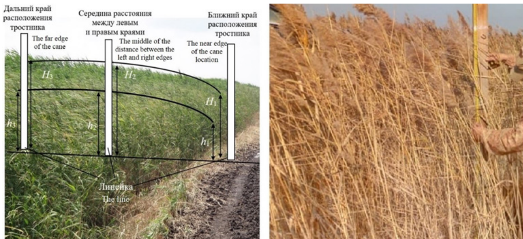
Р и с. 16. Измерение высоты тростника F i g. 16. Measuring reed height
