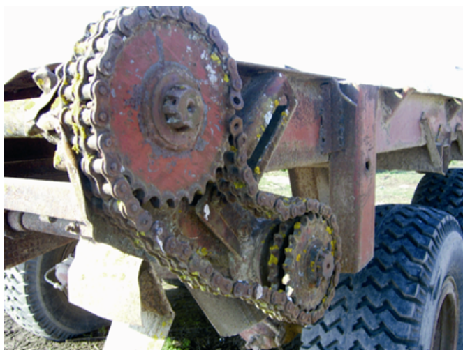
Р и с. 1. Коррозионные разрушения зубьев звездочек и втулочно-роликовых цепей Fig. 1. Corrosion destruction of teeth of sprockets and bushing-roller chains
