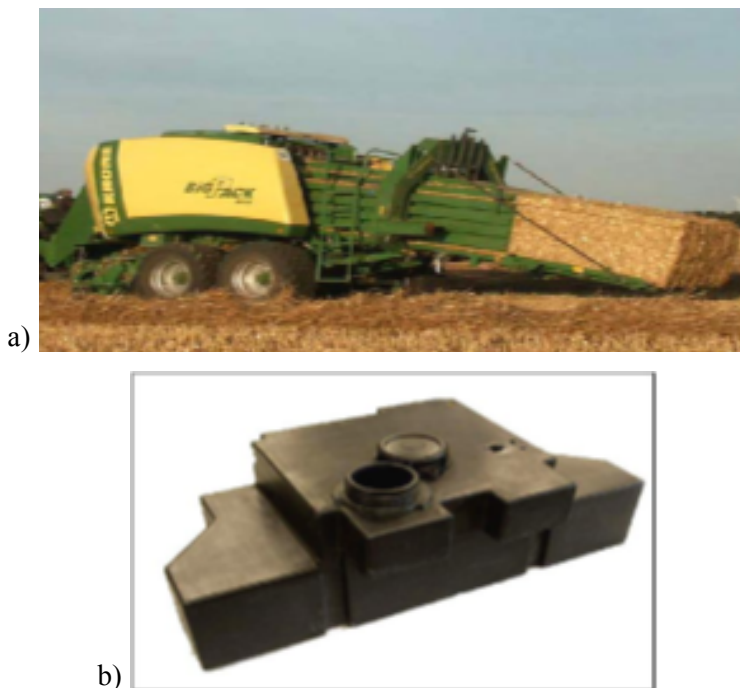
Р и с. 1. Корпусные детали из композитных материалов: а) соломоподборщик; б) топливный бак
